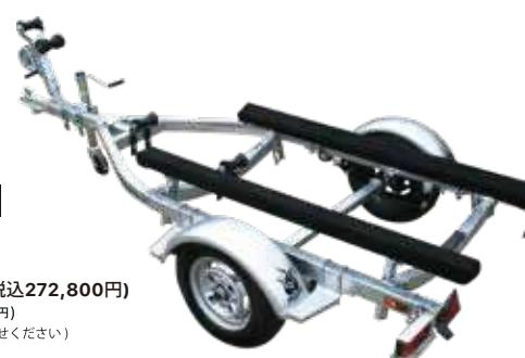
ライトボートに合わせて板バネを2枚に変更して足回りを柔らかく、フェンダーも従来よりも70mm低くすることによりボート積載も低くなります。専用ウインチ&適所にキーローラーを標準装備するなど専用トレーラーならではのアイテムがいっぱいです。
